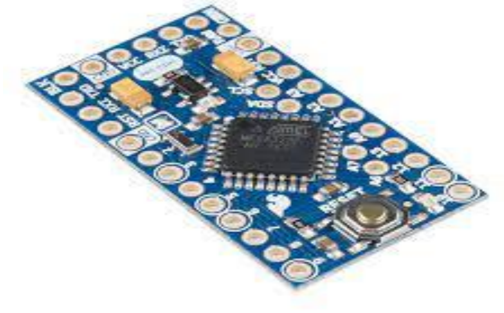
Figure 8 : Description de la carte Arduino Pro mini.
