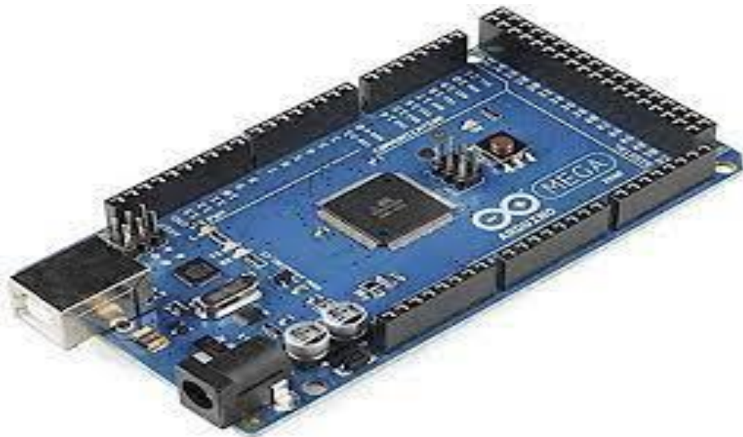
Figure 4 : Description de la carte Arduino MEGA.
