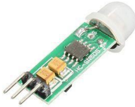
Figure 17 : Exemple d'un détecteur de mouvement utilisé dans notre travail.
