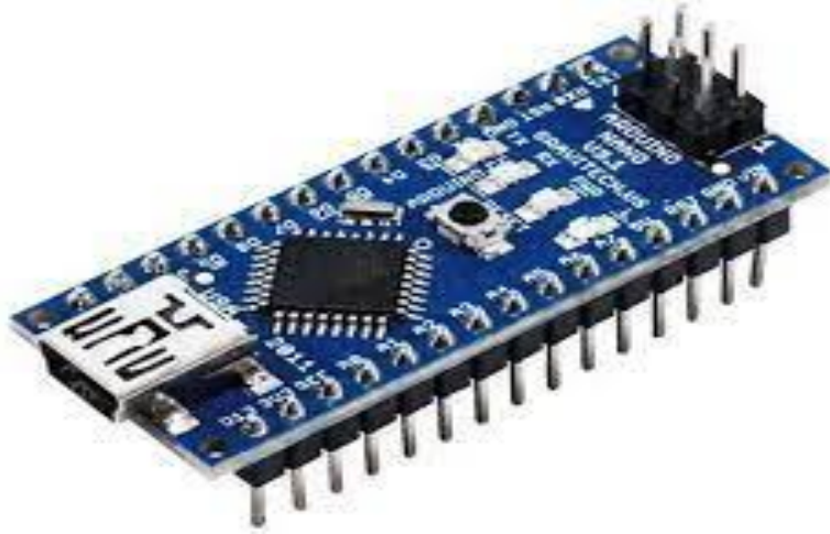
Figure 5 : Description de la carte Arduino NANO [3].
