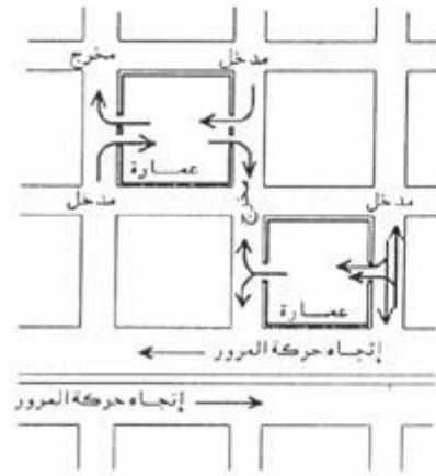
شكل رقم (١١) نموذج تخطيطي يوضح أماكن مداخل ومخارج مواقف السيارات
