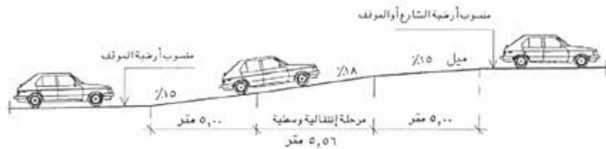
شكل رقم (١٤) يوضح قطاع رأسي لمنحدر مستقيم ومراحله الانتقالية والوسيطية
