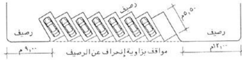
شكل رقم (٣) الحد الأدنى لبعدها المواقف المائلة عن تقاطعات الطرق
