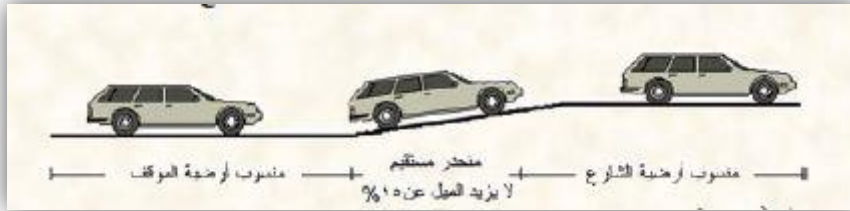
الشكل (16): شكل ميل المنحدر المستقيم في حالة زيادة الميل عن 15%
