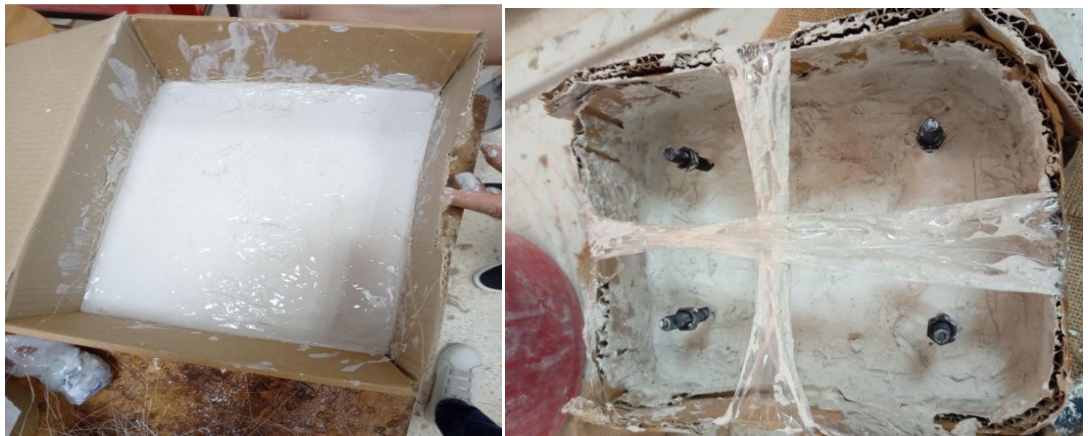
Fig.V.13. La plaque trempée dans le plâtre
