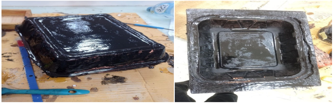
Fig.V.14. Moule et contre moule
