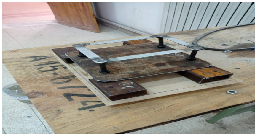
Fig.V.11. Mécanisme de fixation du gabarit
