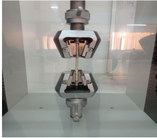
FigV.10. Dispositif pour la traction deux points
