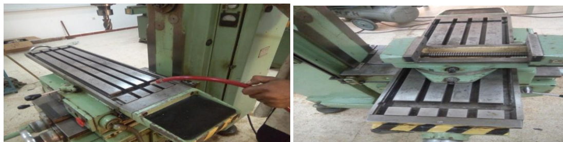
Fig.III.31: les nettoyé des glissières.
