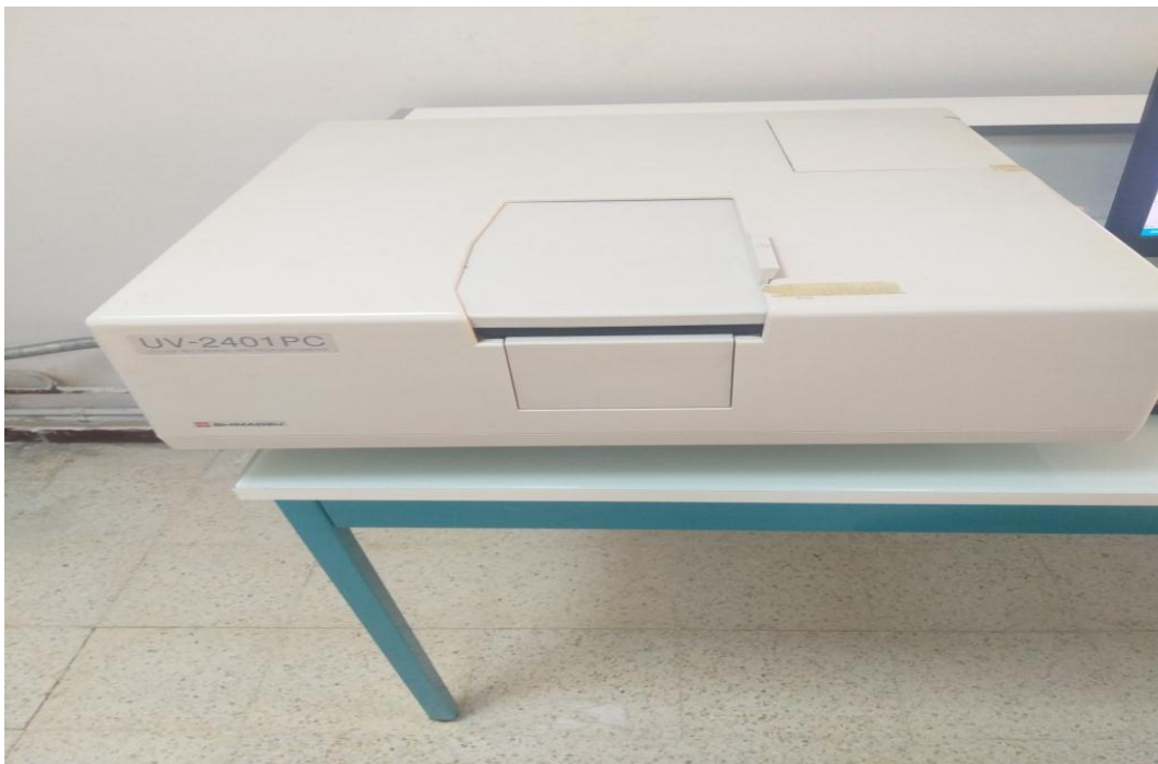
Figure II.9 : Dispositif représentant le spectrophotomètre UV visible utilisé
