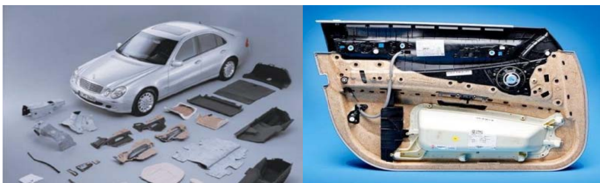
Fig.3. Pièces intérieures de véhicules de constructeurs allemands constituées de bio composites [8]
