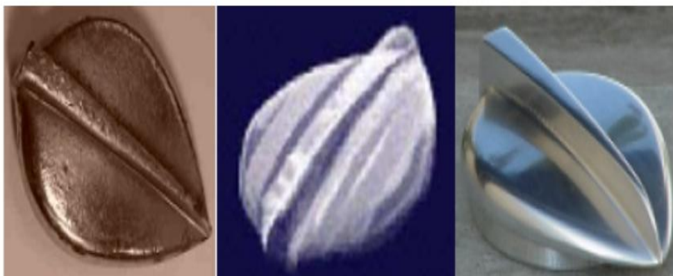
Fig. 1.4 Rétro-conception d'un bouchon de Delahaye
