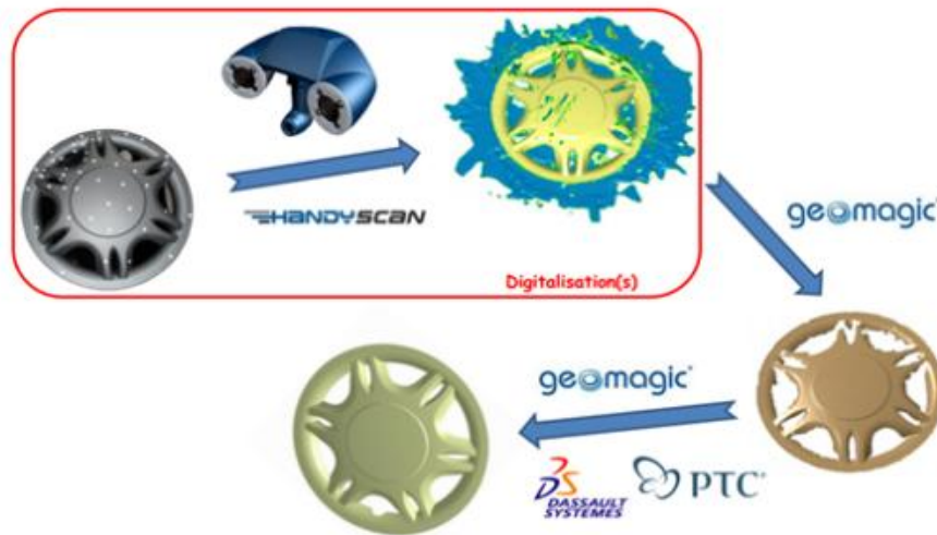
Fig. 2.13. : Exemple de rétroconception avec Geomagic™
