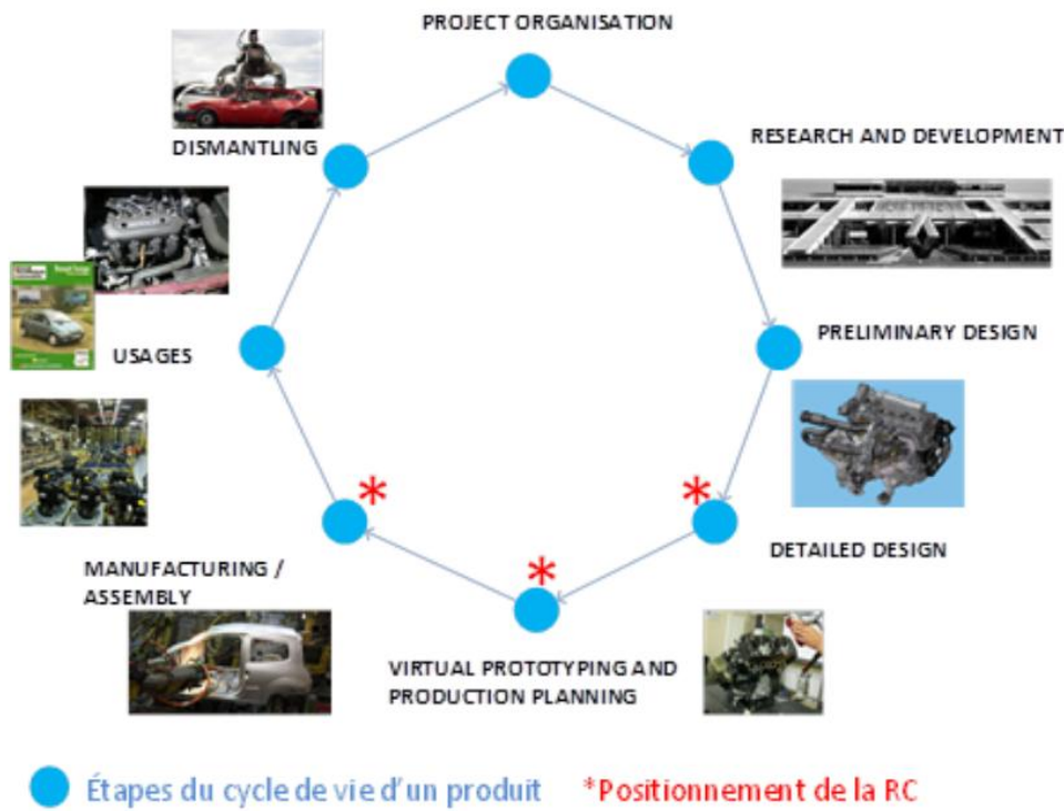
Fig. 1.2 Cycle de vie d'un produit, positionnement de la RC.
