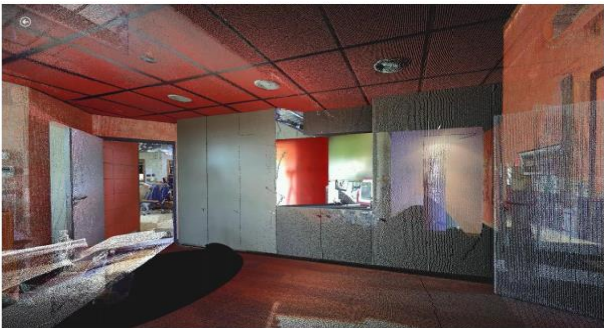
Figure II.8 : Nuage de points colorisé issu d'un relevé au Scanner laser 3D [9]
