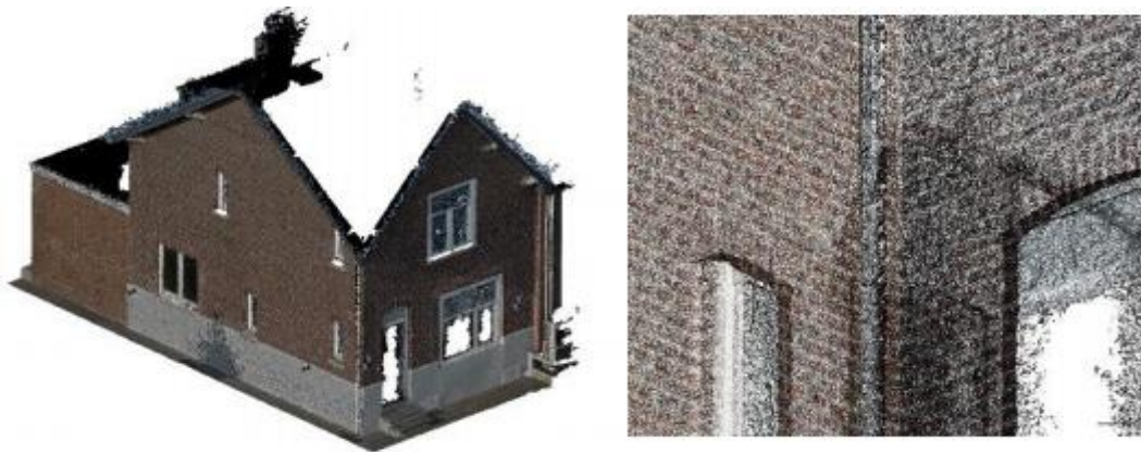
Figure II.16 : Un nuage de points de haute résolution avec information [2]
