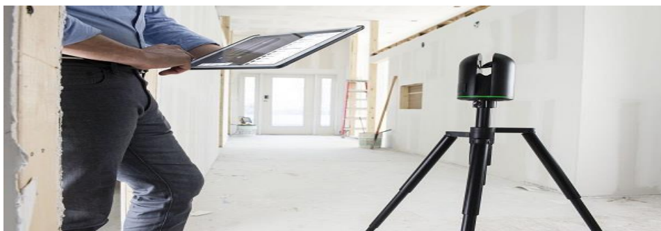
Figure I.19 : Le scanner 3D Leica BLK360 numérisant Bâtiment
