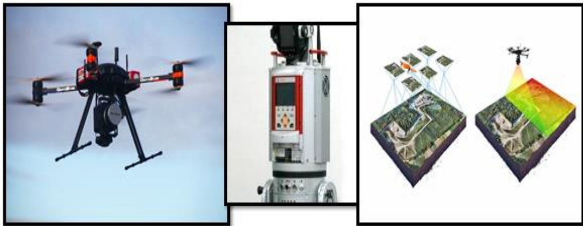
Figure II.2 : Scanner laser 3D en station pour le relevé terrestre
