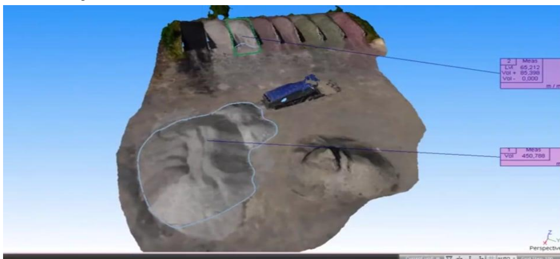
Figure III.28 : Calcul du volume entre deux surfaces différentes niveaux
