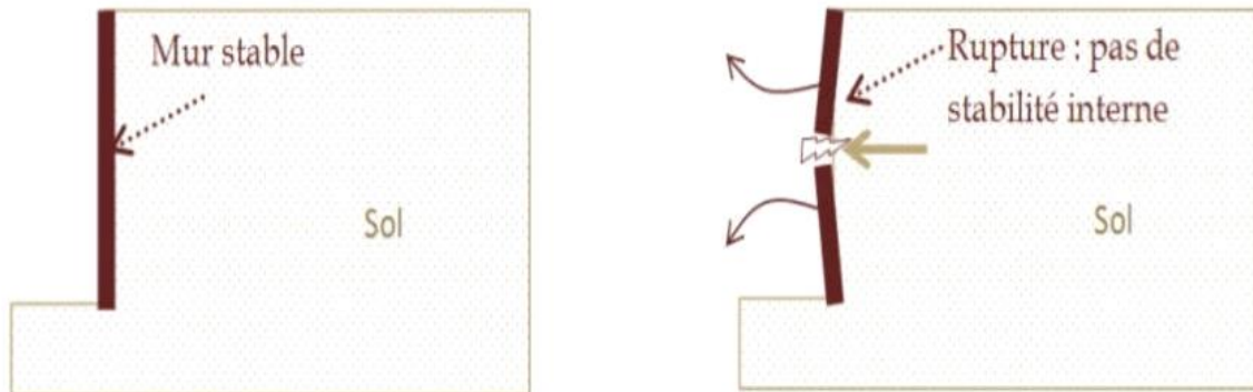
Figure I.6: Modes de rupture des ouvrages de soutènement.
