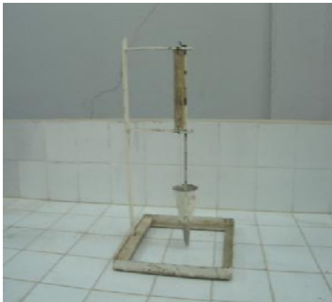
Figure III.6 Mesure de la fluidité du mortier.
