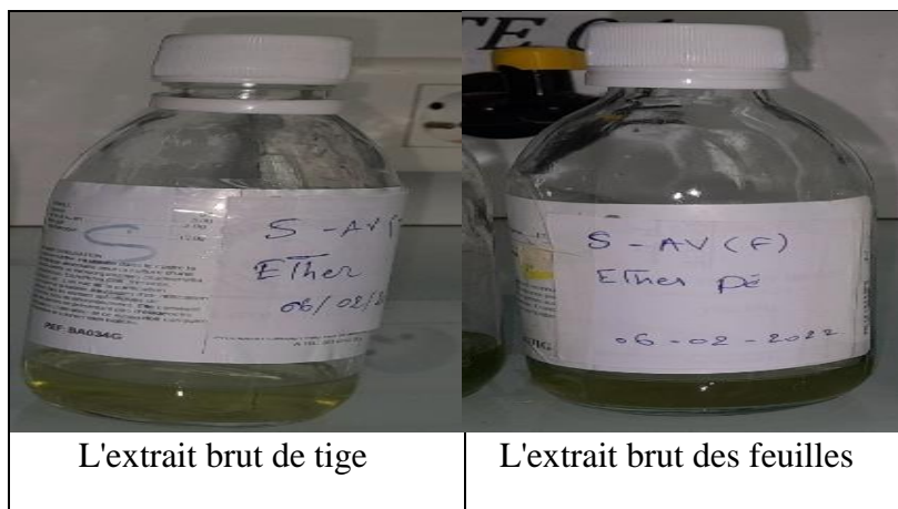
Figure 9 : L'extrait brut de feuilles et de tiges par soxhlet
