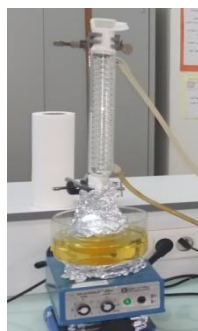
Figure.III.3: Montage de chauffage à reflux avec réfrigérant à eau
