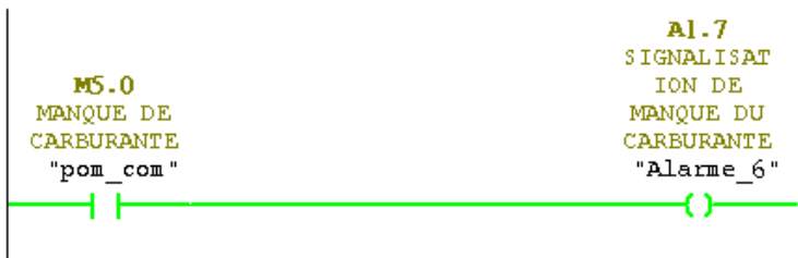
Figure .IV.37 : signalisation de manque de combustible
