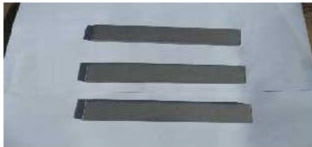
Figure III.4: les substrats après le sablage
