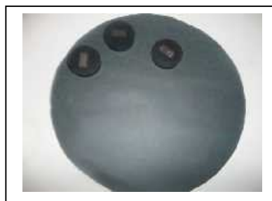
Figure III.5 : L'échantillon subi un polissage.
