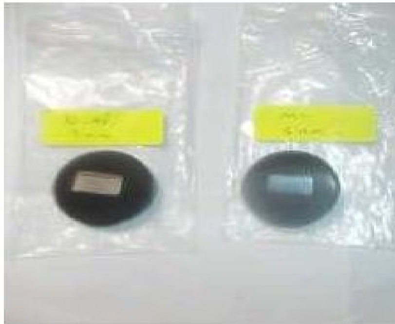
Figure III.7 Echantillon de prélèvement de la micro-dureté des éléments enrobé.
