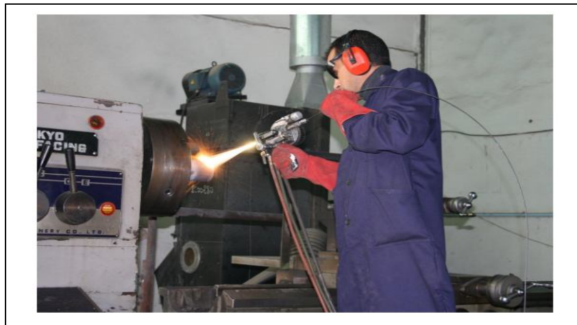
Figure-II.14 : Poste de métallisation à la flamme en fil (MEI)
