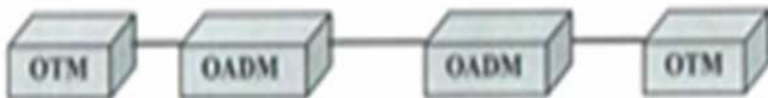
Figure I.11 Topologie linéaire insertion-extraction d'un réseau DWDM [11].
