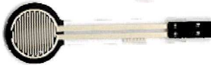
Figure I-4 : Capteur de pression avec film polymère FSR data sheet (Interlink). Diamètre 15 mm, épaisseur 1 mm.
