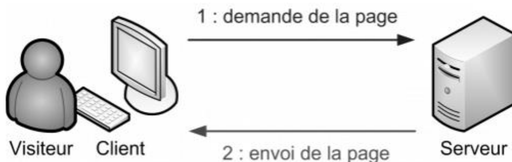
Figure 1: Fonctionnement d'un site web entièrement statique [8]
