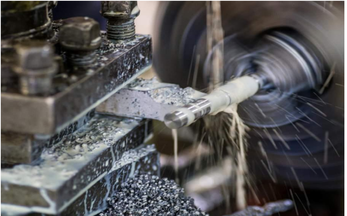
Figure III.3 préparation de l'éprouvette de l'essai de traction.
