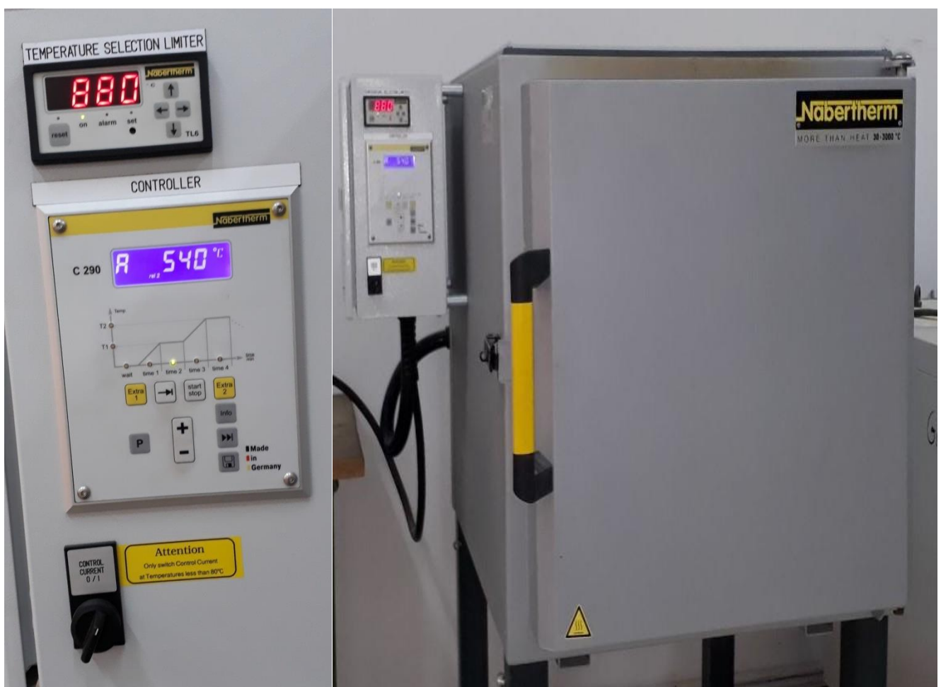
Figure III.5 four de traitement thermique
