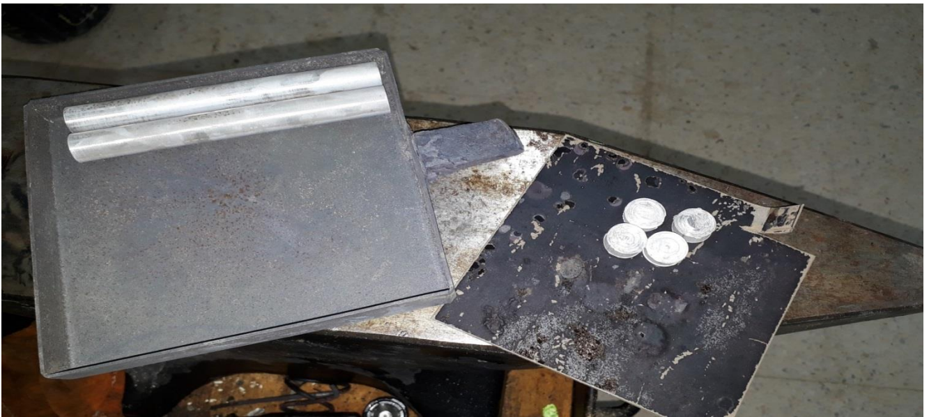
Figure. III.6 éprouvette et échantillons trempé à l'air ambiant.
