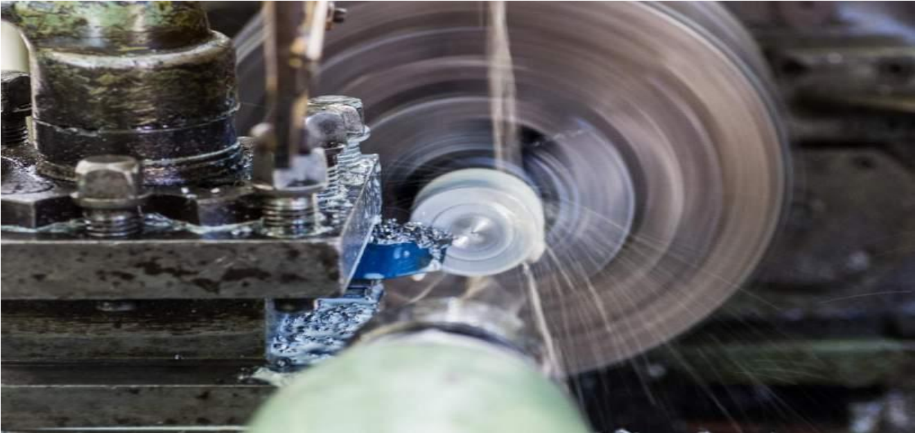
Figure III.1préparation l'éprouvette d'essai de dureté.
