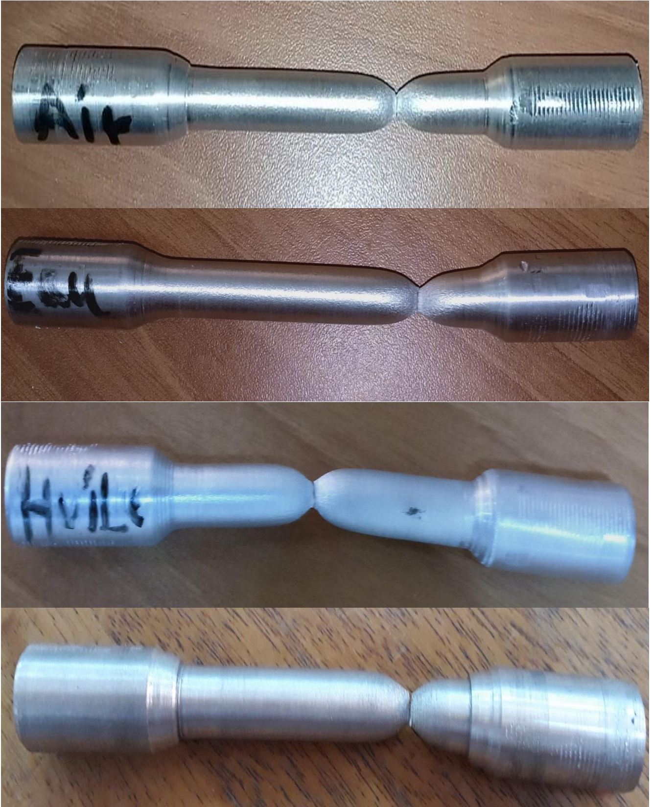
Figure III.11 éprouvette après l'essai de traction
