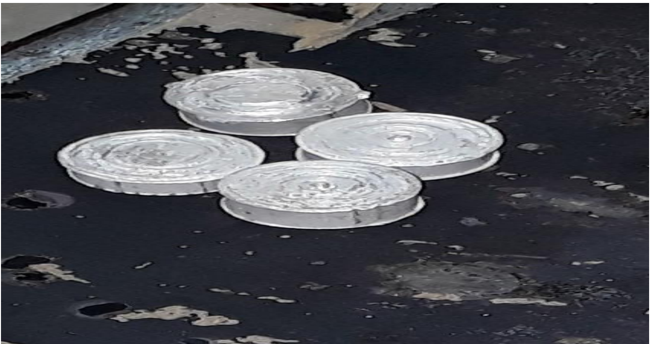
Figure III.2 Eprouvette finie pour la dureté
