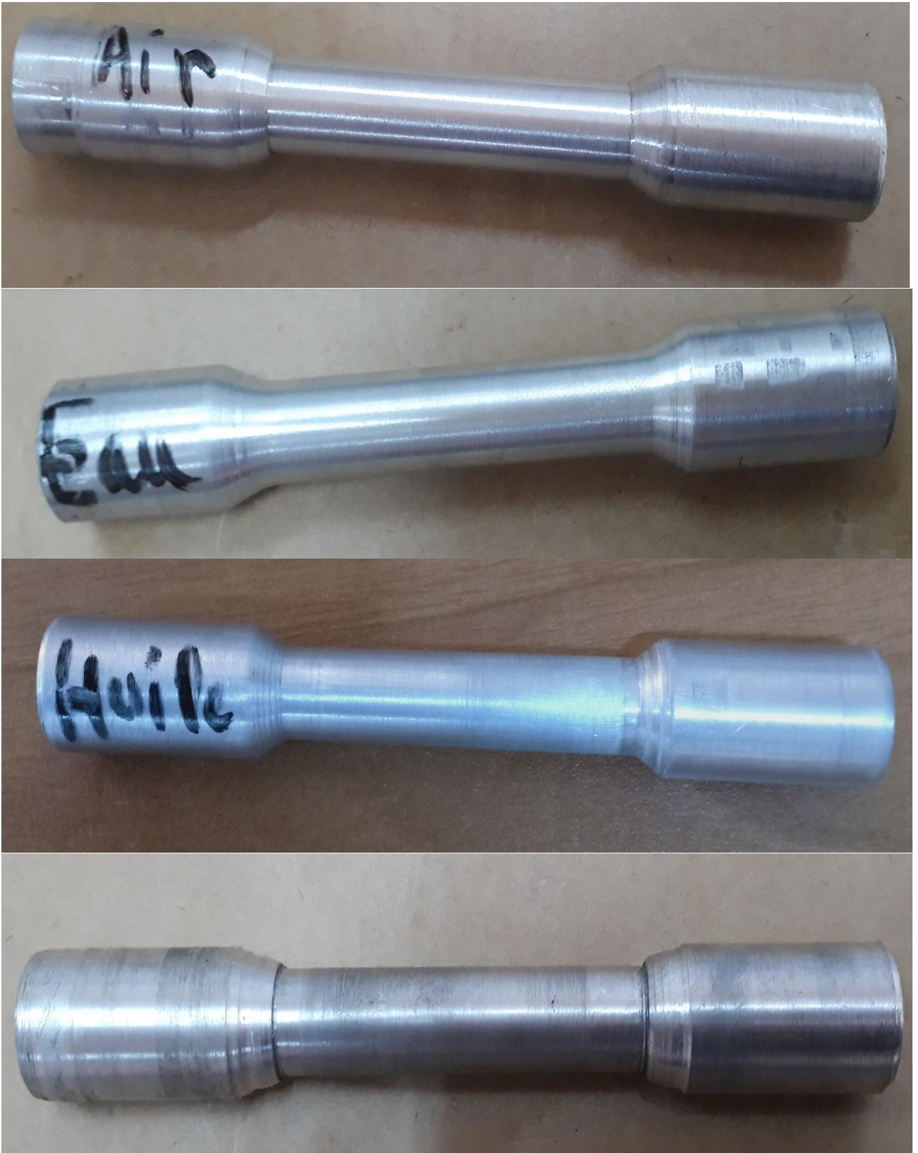
Figure III.9 éprouvette avant l'essai de traction
