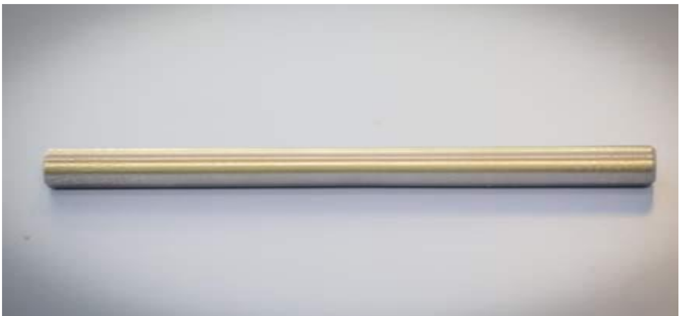
Figure III.4 Eprouvette finie pour la traction
