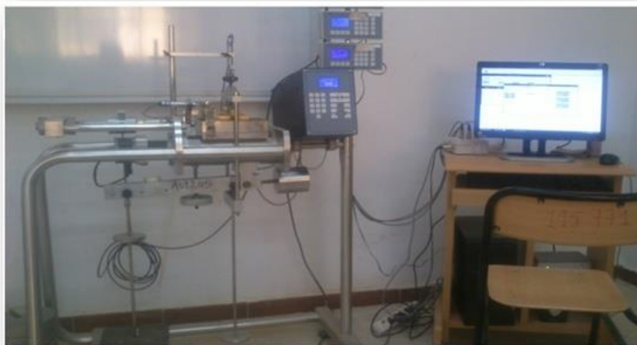
Figure 2.5 Appareil de cisaillement direct (Université de M'sila, Département de Genie civil, Faculté de Technologie)
