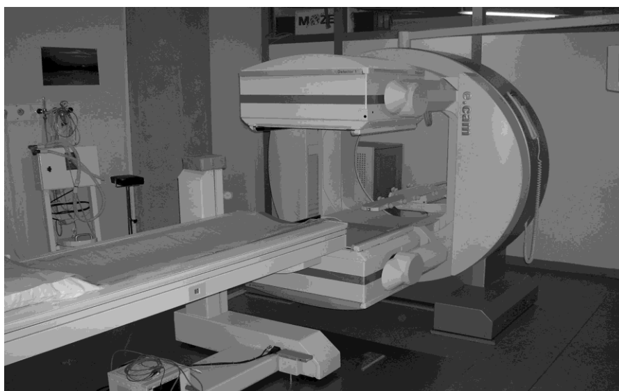
FIG I.6 : Exemple de gamma caméra: la Siemens E-CAM Signature du CHU de Liège. Deux détecteurs qui permettent d'acquérir les données plus rapidement en effectuant seulement un demi-tour autour du patient.
