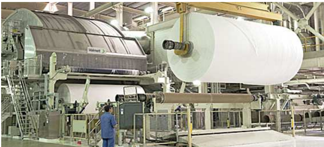
Figure III.4. Déplacez le rouleau-mère du site de production vers le site de traitement.
