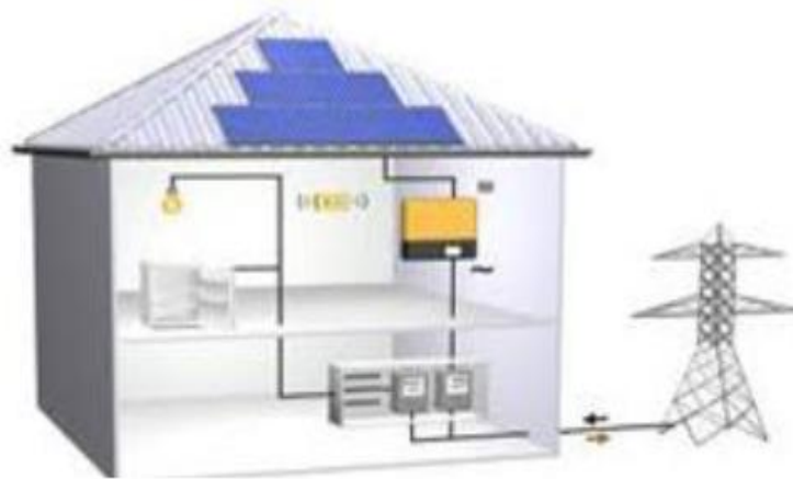
Figure III.11: Structure d'un système PV raccordé au réseau [11]
