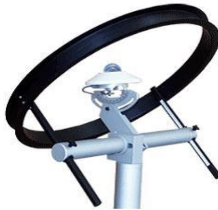
Figure I.11: Pyranomètre muni d'une bande pare-soleil [24]
