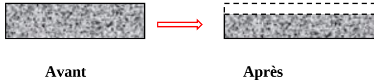
Figure I.2. Schéma représentant une pièce métallique avant et après la corrosion généralisée.
