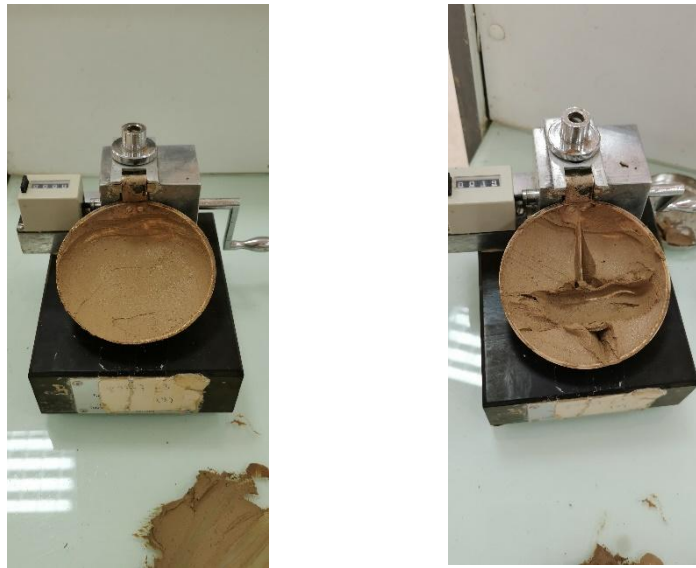
Figure IV.8 : Appareillage d'essai des limites d'Atterberg
