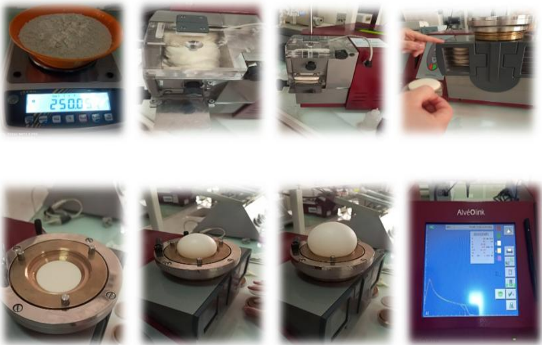
Figure8. Les étapes de test d'alvéographe de Chopin
