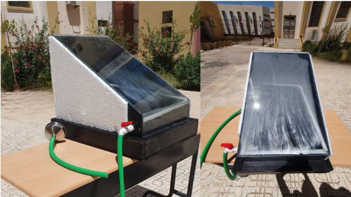
Figure III.2: Conception du distillateur solaire
