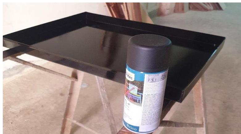
Figure III.4: peinture de bassin
