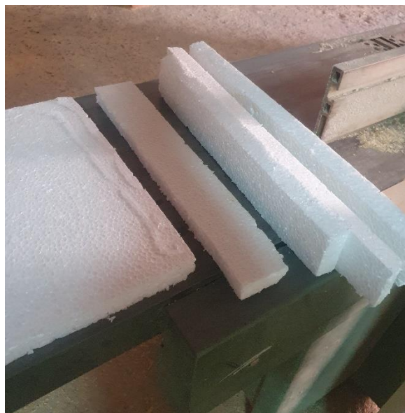
Figure III.5: Découpage du polystyrène
