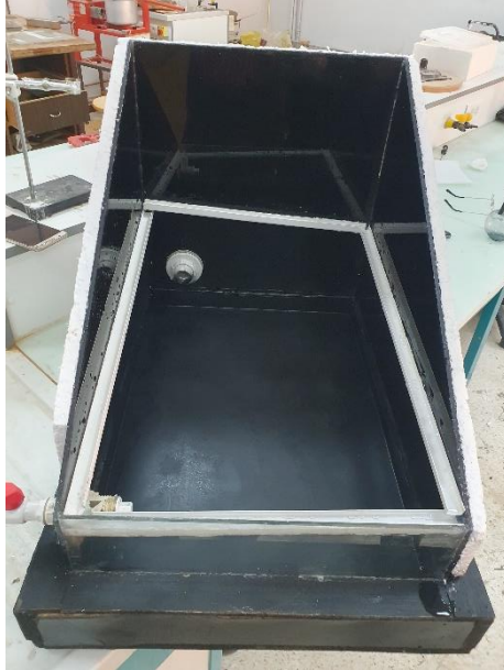
Figure III.10 :Installation des isolation, les canaux, l'entrée et la sortie
