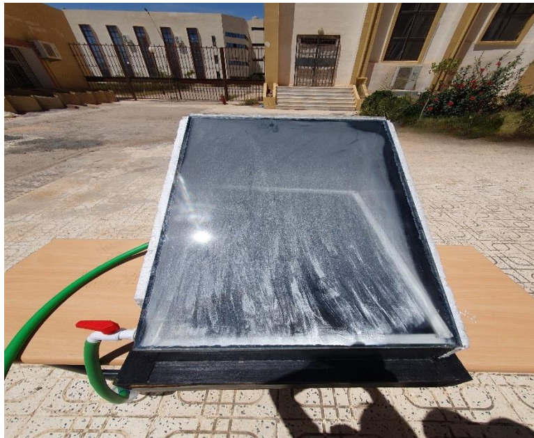
Figure III.11 :Le distillateur solaire
