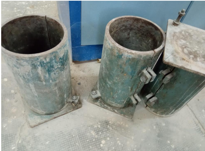
Figure III.9 - Moules cylindriques utilisés pour la fabrication des éprouvettes.
