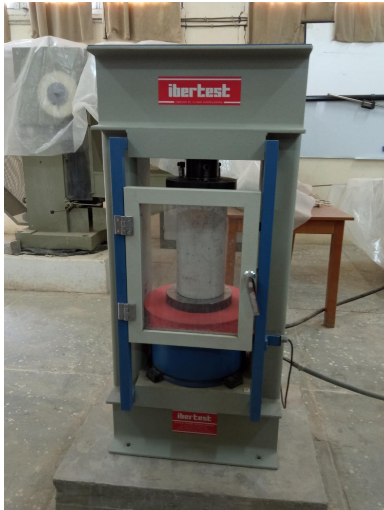
Figure III.10 - Essai de compression simple sur éprouvette de BAP.
