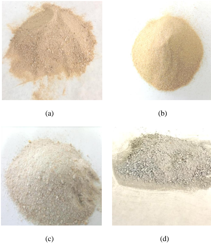
Figure III.2 - Sables utilisés: (a) sable de dunes de Bou Saada ; (b) Sable de dunes d'Elma Labiod ; (c) Sable de rivière d'Elkouif; (d) Sable concassé d'Elma Labiod.
