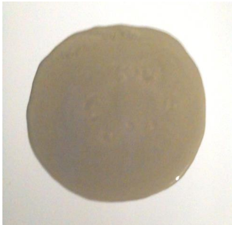
Figure III.6 - Étalement de la pâte autoplaçante.
