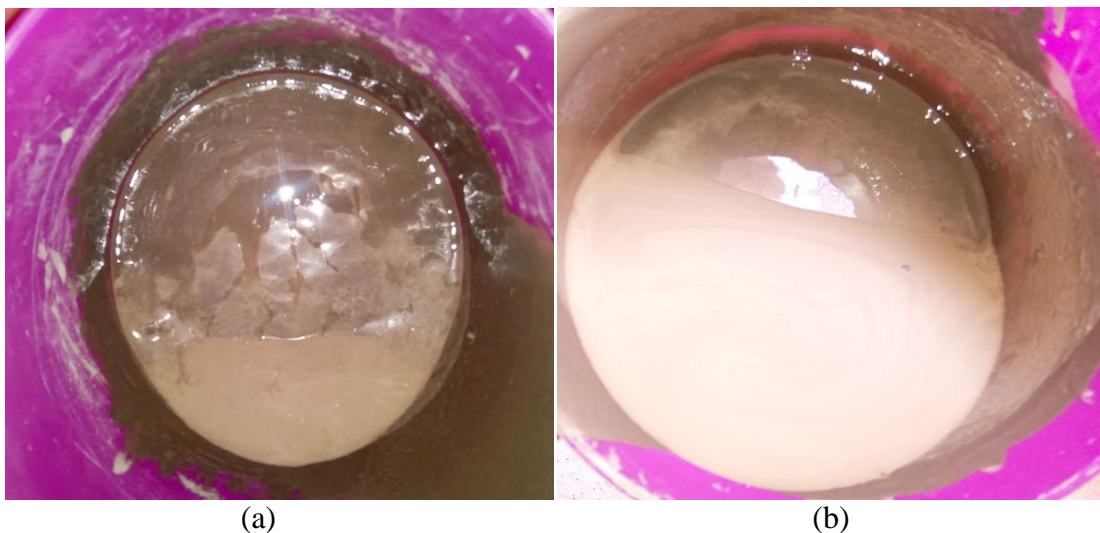
Figure IV.6 - Ressuage de la pâte autoplaçante contenant le SikaPlast - 40 Pro: (a) à 5 minutes ; (b) à 60 minutes.
