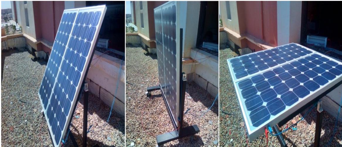
Fig.III.6 : Inclinaisons du panneau solaire
