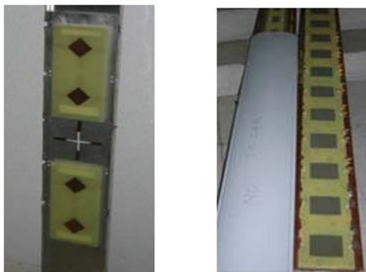
Figure I.8. Exemple de réseaux d'antennes élémentaires
