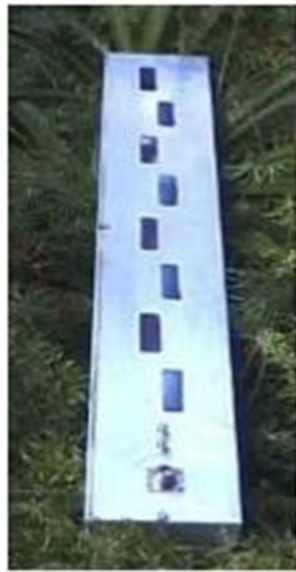
Figure I.9. Exemple d'antenne à fentes
