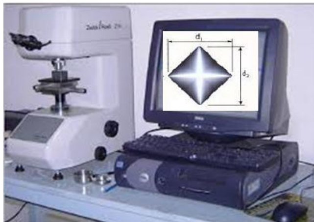
الشكل (10-II): جهاز قياس الصلادة المجهرية.
