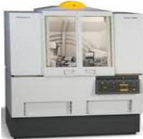
الشكل (2-II): جهاز حيود الأشعة السينية.
