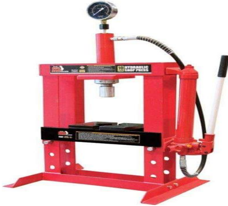
الشكل (5-II): جهاز الضغط الهيدروستاتيكي.
