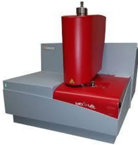
الشكل (II-4): جهاز التحليل الحراري الكتلي التفاضلي.
