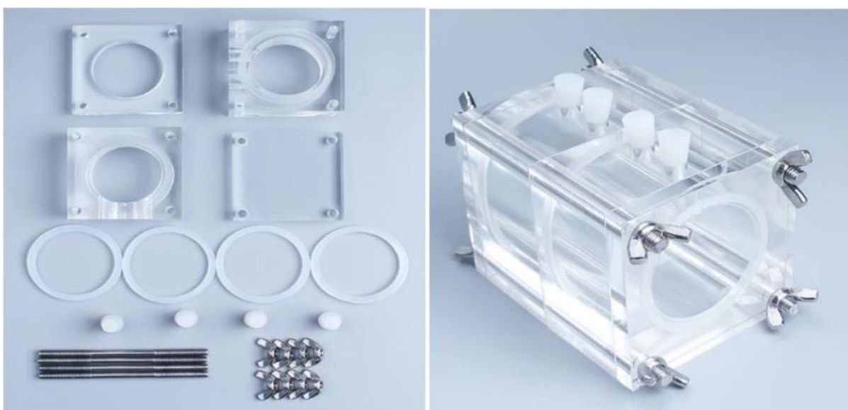
Figure II.1 : Les éléments constitutifs de la cellule (à gauche) avec les accessoires d'assemblage de ces éléments et une photo de la cellule assemblée (à droite).
