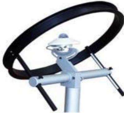
Figure I.5 :l'instrument qui meure le rayonnement diffus [12].
