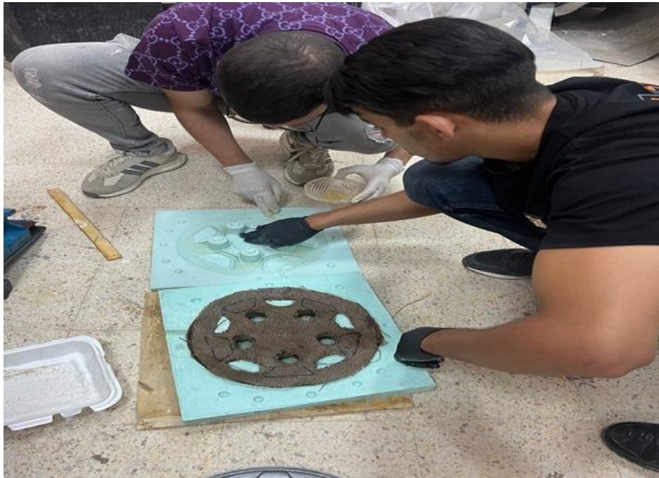
Figure VI.8: Mise en place dans le moule
