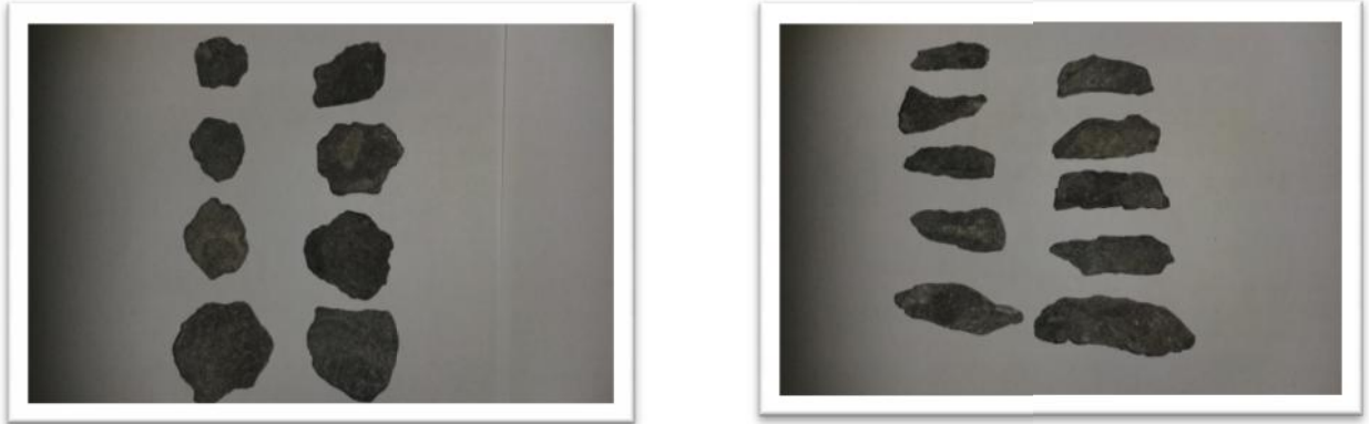
Figure 6 : gravier concassée à forme aiguilles et plaquette.
