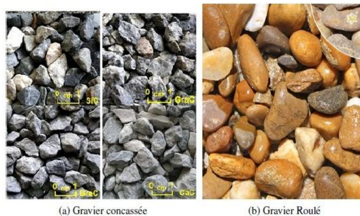
Figure 5 : gravier concassée et gravier roulé
