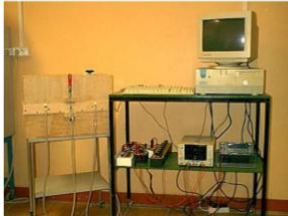
Figure. III.7. Dispositif utilisé pour la mesure de la conductivité thermique [14].
