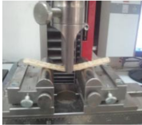
Figure. III.3.Essai de flexion sur machine de flexion de type Zwick [9].
