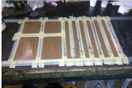
Figure. IV .1. Préparation d'un composite à base de la sciure de bois d'un moule [1].
