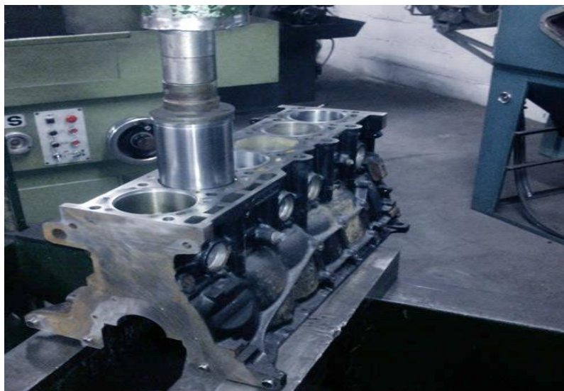
Figure III .3. L'opération de réalésage de cylindre.
