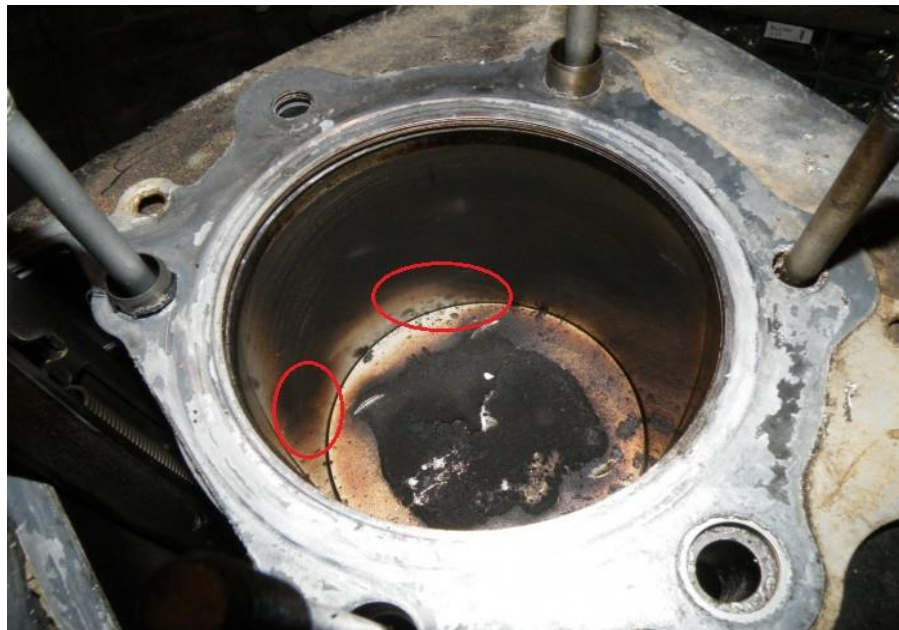
Figure III .1. Brûlures et usures dans l'alésage des cylindres
