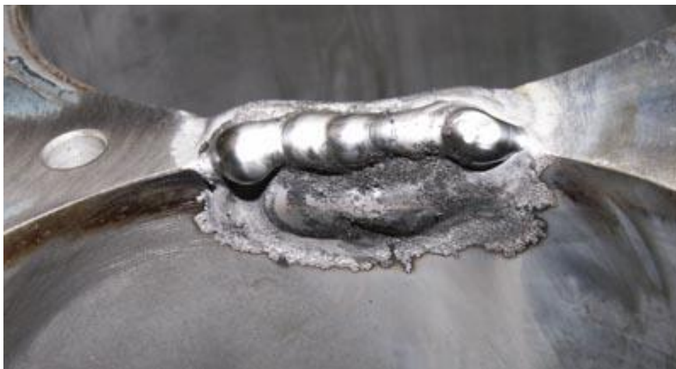
Figure III .2. Rechargement des zones défectueuses
