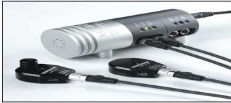
Figure II.4 Compensateur XC-80 et ses capteurs [39].
