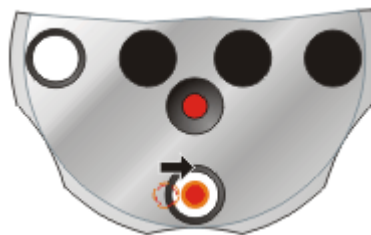
Figure II.22 effectuer une translation horizontale du laser et amener les deux faisceaux au centre de la cible [39].
