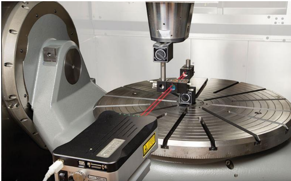
Figure II.1 Mesure par l'interféromètre laser [37].
