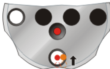
Figure II.20 monter ou descendre la tête laser pour amener les deux faisceaux au centre.
