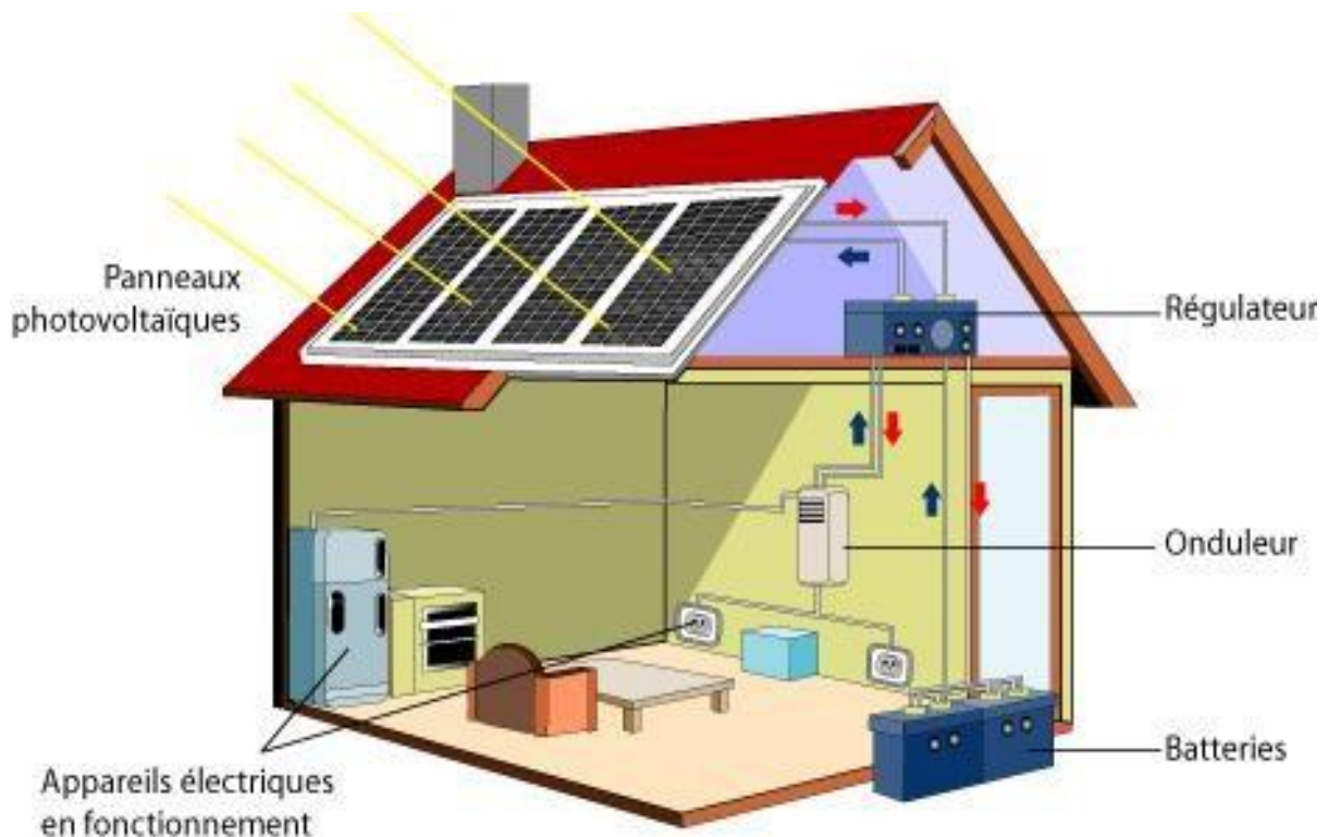
Figure (II.1) : structure de l'installation photovoltaïque autonome [28].
