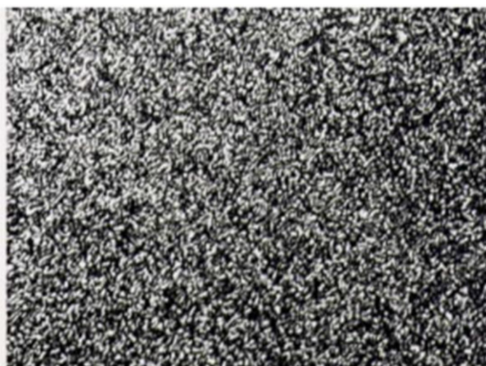
Figure 4.7 : Photographie de speckle (granularité laser) [26].
