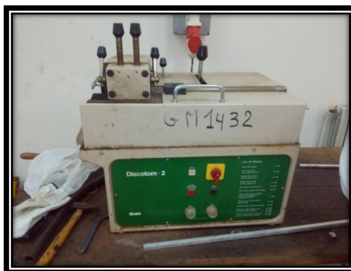
Figure.5.2 : Découpage a disque modèle Discotom-2
