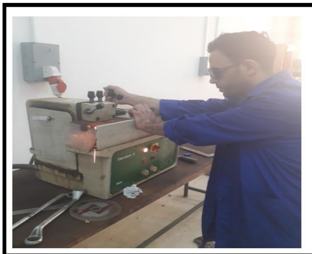
Figure.5.3 : opération de découpage d'échantillons
