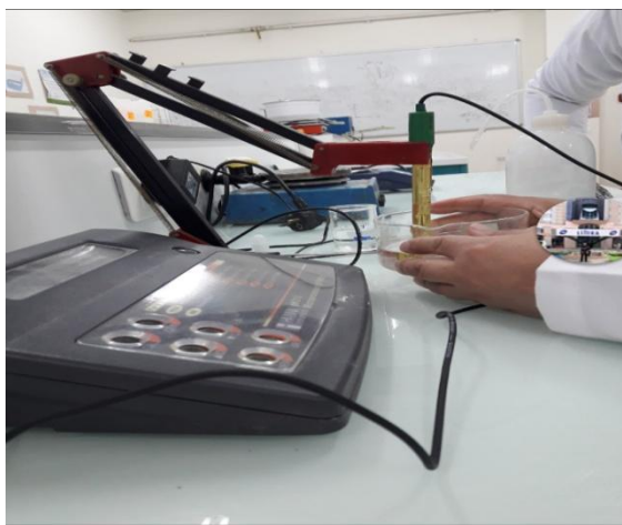
Figure III.9: pH-mètre de type HANNA pH211.
