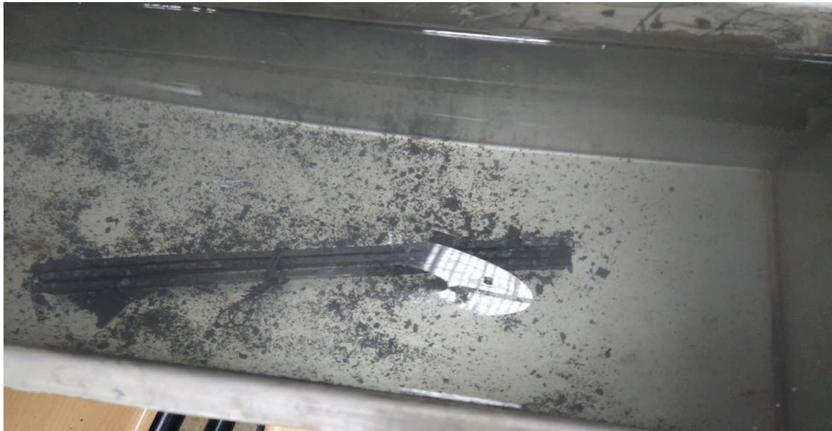
Figure III.13 : Refroidissement par l'eau des éprouvettes après TTH.
