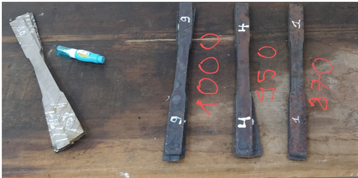
Figure III.14 : Refroidissement par l'air
