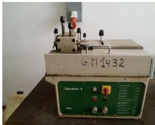
Figure 3.2: machine coupement à froid Discotom-2.
