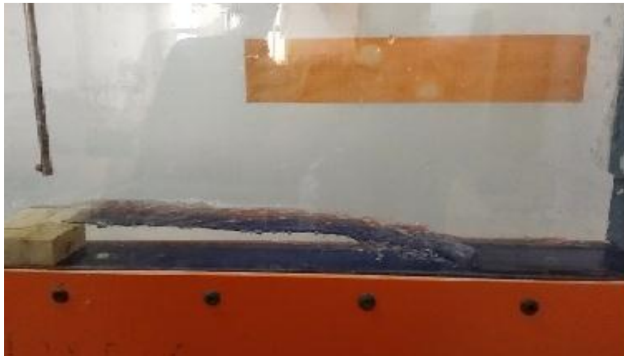
Photographie 2.1 : Ressaut hydraulique contrôlé par seuil épais dans un canal rectangulaire a pente nulle
