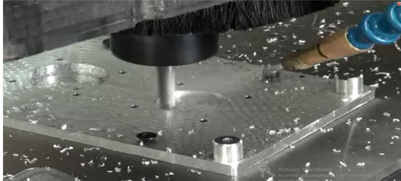
Figure 1.3 : Fabrication d'un alésage en fraisage circulaire.
