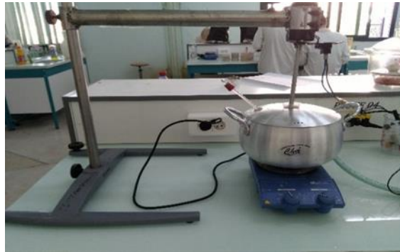
Figure 5 : Le montage présentant le procédé utilisé pour la préparation de la boisson lactée.
