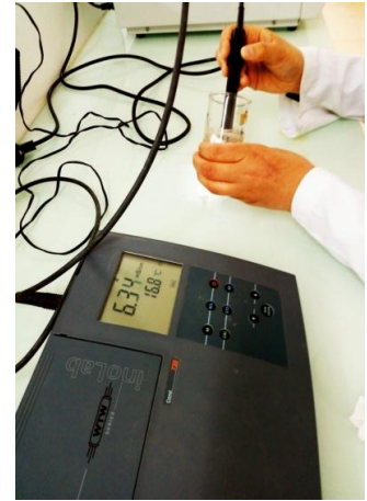
Figure 2 : Mesure de la conductivité électrique d'un sol (CE)
