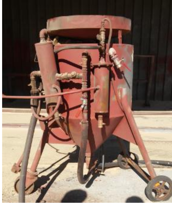
Fig. III.15. : Dispositif de sablage. -ACI-
