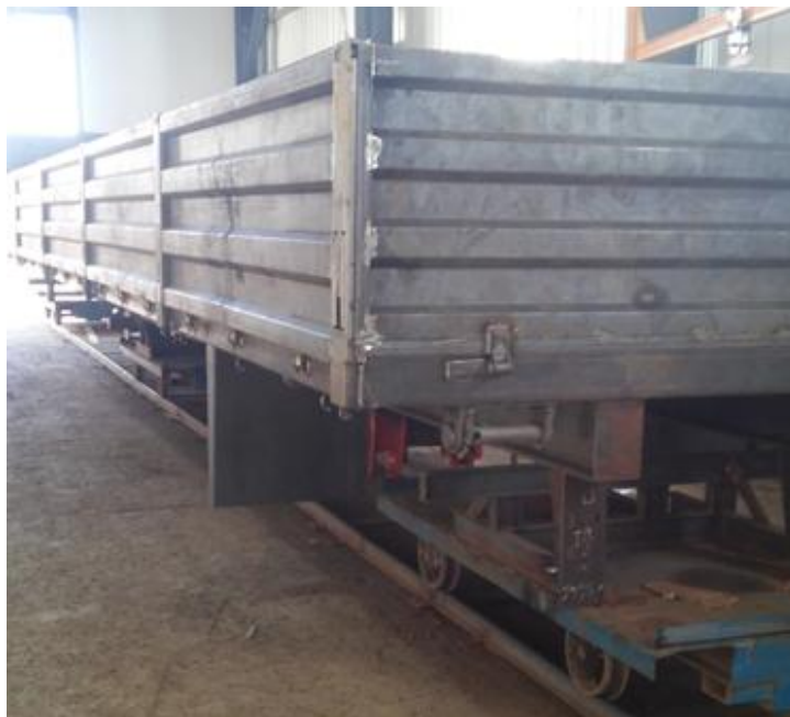
Fig. III.14. : L'installation des portes latérales et la porte arrière de la remorque -ACI-
