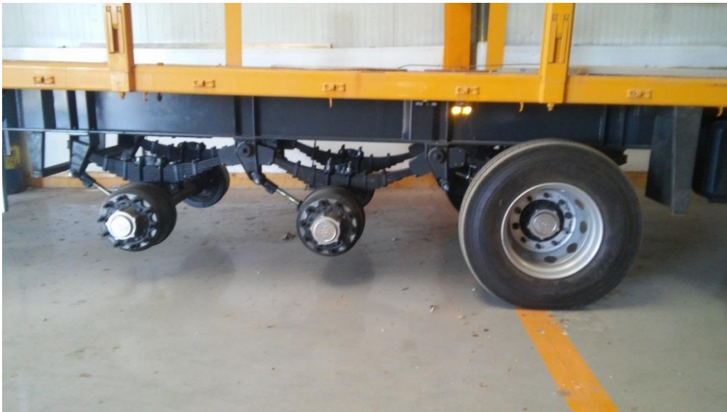
Fig. III.18. : Installation du système de marche -ACI-
