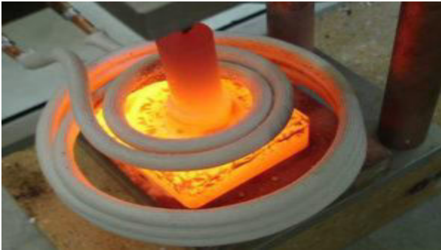
Fig. I.8 : recuit acier et normalisation par induction
