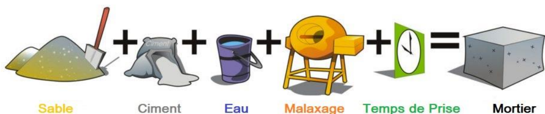
Figure.IV.2. Composition d'un mortier.
