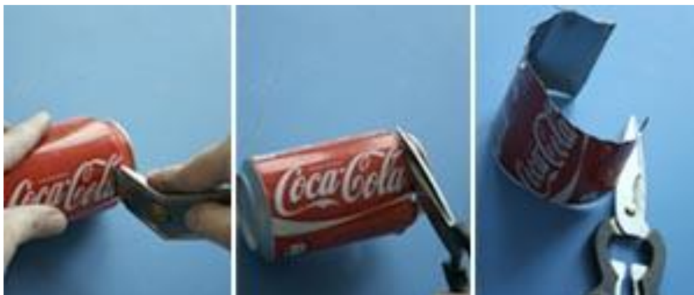
Figure.IV.6. Procédure de découpe des Canneltes en aluminium.
