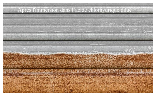
Figure.III.6. Traitement chimique par attaque acide.
