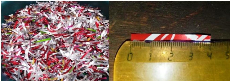
Figure.IV.7. Fibres des Cannelles en aluminium.
