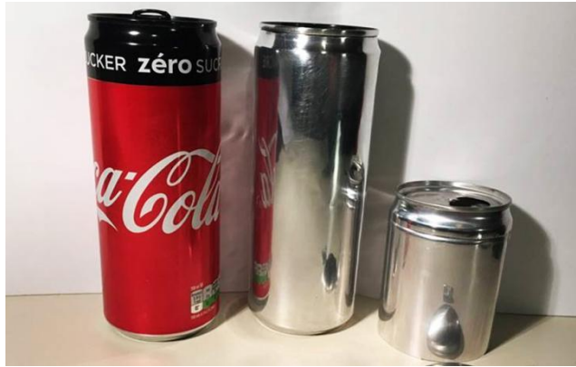
Figure.III.2. Élimination des revêtements et impuretés.
