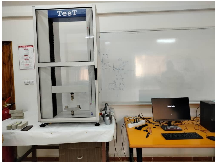
Figure V.2. Machine d'essais universelle installée dans le Laboratoire de Génie mécanique
