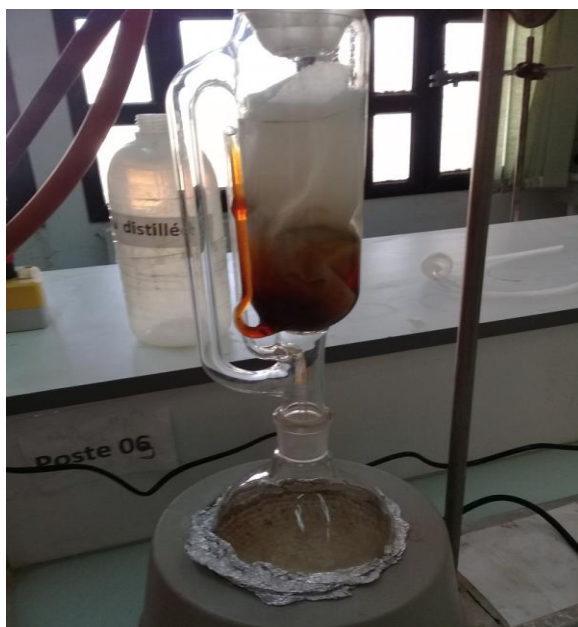
Figure II.1. Schéma de montage d'extraction dans le Soxhlet.
