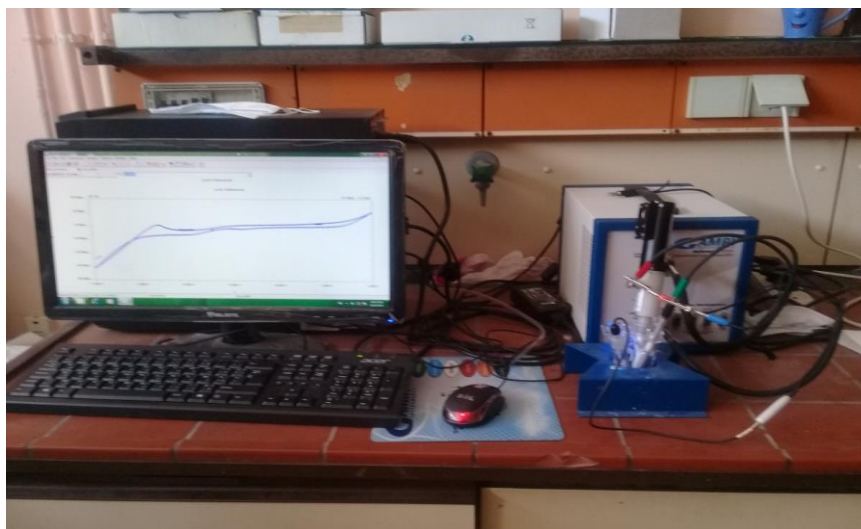
Figure II.4: montage d'appareillage expérimentale potentiostat galvanostat Gamry.
